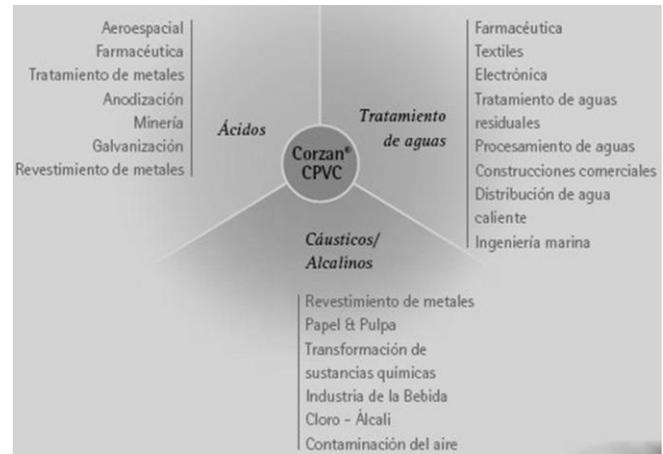
La tubería de CPVC **CORZAN®** de **Durman**, es utilizada para aplicaciones que requieren una alta resistencia a la corrosión, presión, altas temperaturas o a la intemperie.
